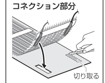
3. アモマットと断熱材がズレないようにタッカーで固定する。
